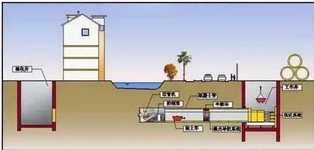
图 3.2-3 顶管施工示意图
